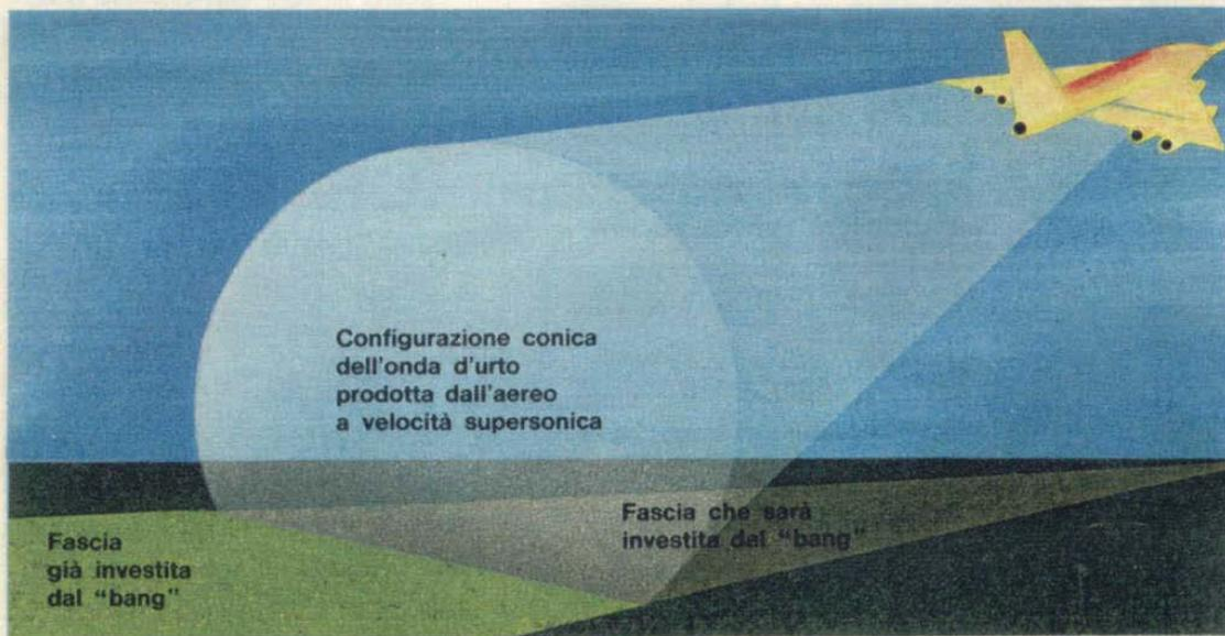
In questo disegno è rappresentata la propagazione delle onde d'urto generate da un aereo che voli a velocità supersonica.
